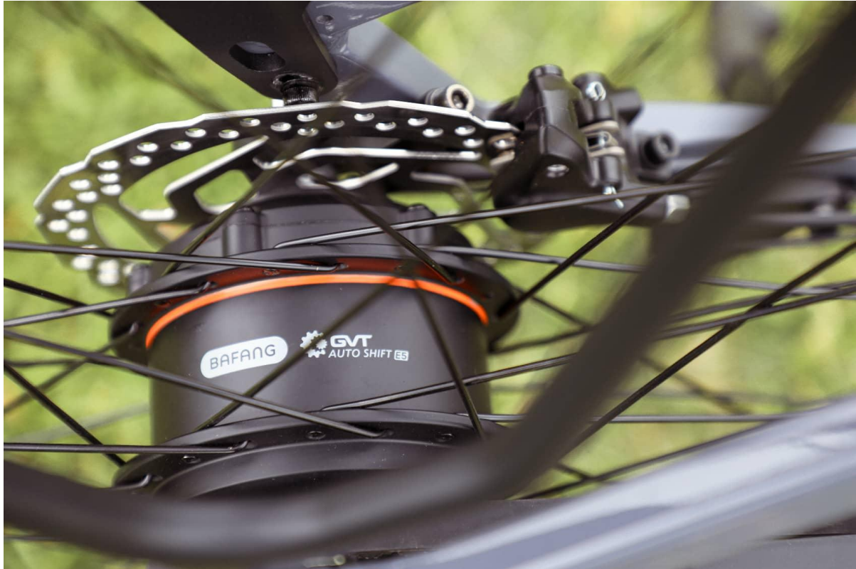
图一：RG E510 手自一体 5 挡电变花鼓
