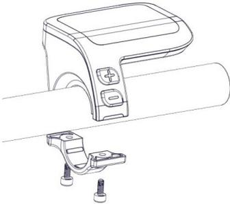
2. Placez maintenant le support de maintien sur la face inférieure de l'écran et serrez-le en position avec 2 vis M1,5\*6. Couple de serrage requis : 0,5N.m.
